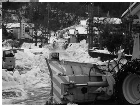
ロータリー車 除雪後の状況
