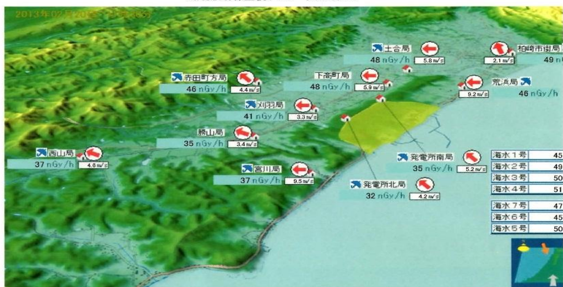
環境放射線監視テレメータシステム
